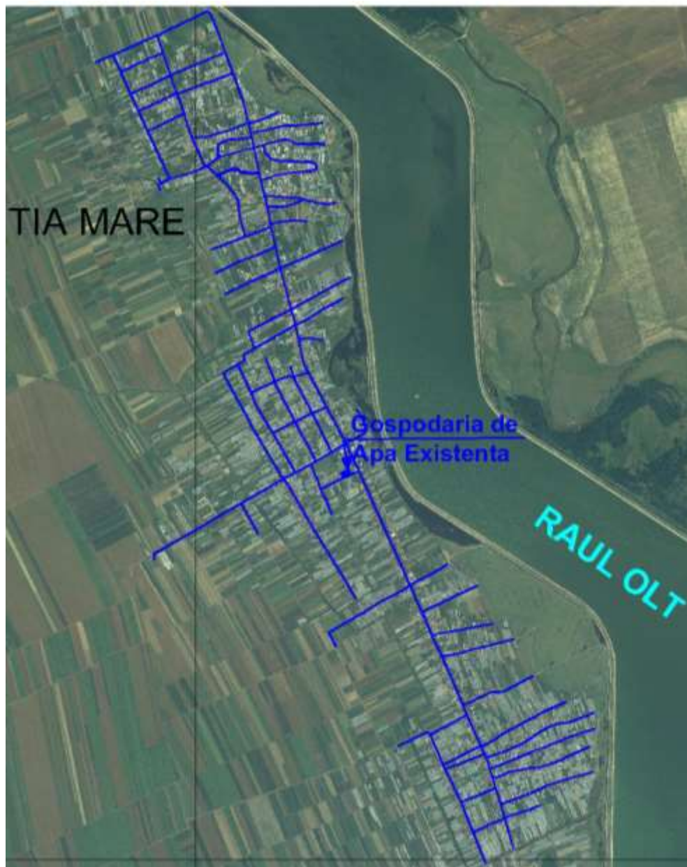
Figura 35 – Sistem de alimentare cu apa Tia Mare in executie
