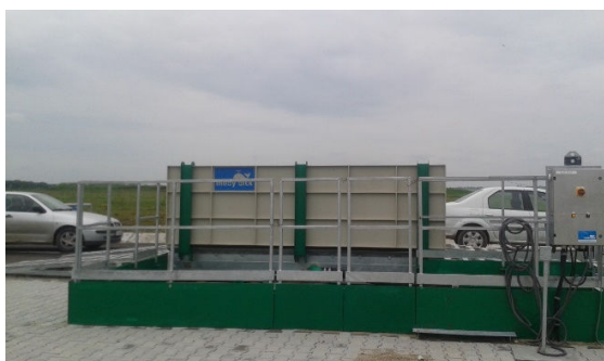
Echipament spălat roți
