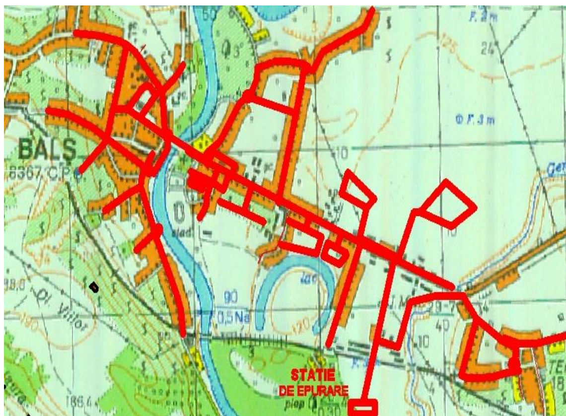
Figura 26 – Descrierea infrastructurii existente – Aglomerare Bals
