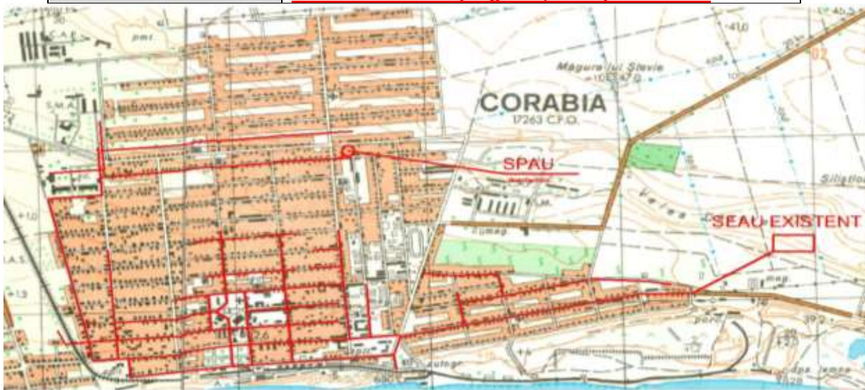
Figura 17 - Descrierea infrastructurii existente – Aglomerare Corabia
