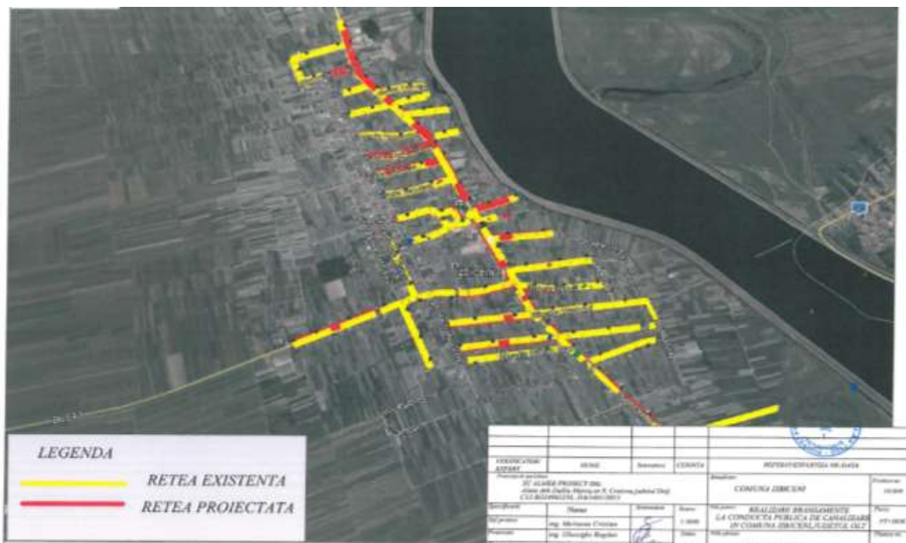
Figura 2 – Proiect de extindere rețea de canalizare și realizare racorduri- Izbiceni
