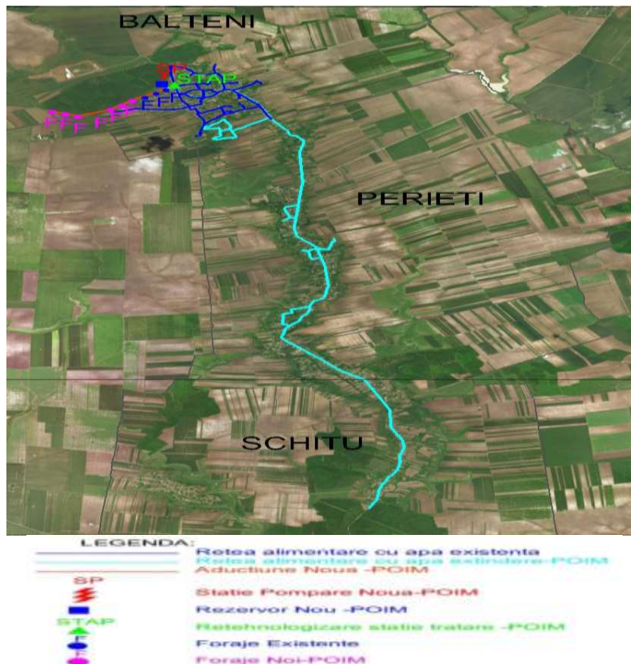
Figura 14 - Descrierea infrastructurii existente – sistemul de alimentare cu apă Balteni
