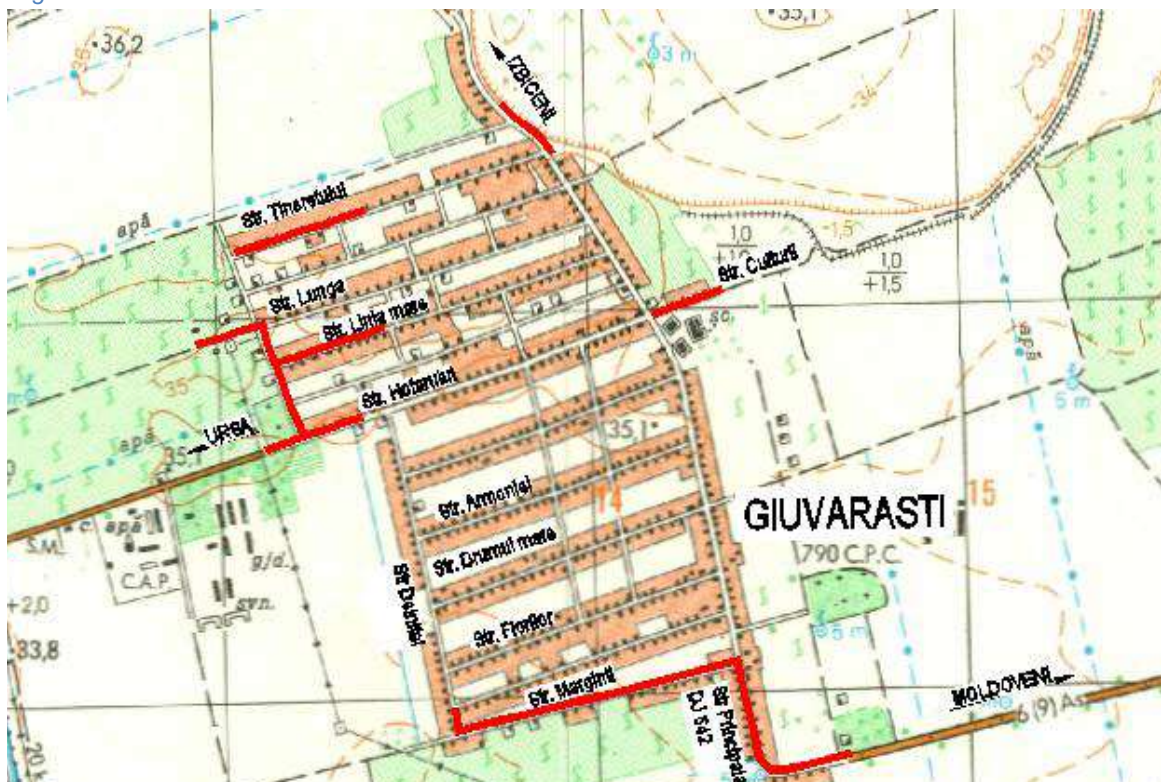
Figura 5 – Proiect de extindere a rețelei de canalizare Giugarasti-Sursa de Finanțare PNDL
