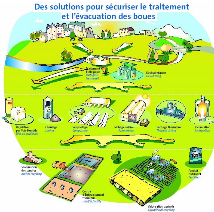
Figura 5.2 Imagine ilustrând un posibil tratament pentru nămolul provenit de la instalațiile de tratare a apei uzate (SITA France)
