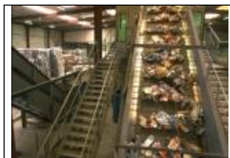
Fig 6.9 Facilități de sortare arătând reciclarea deșeurilor uscate pre sortate
