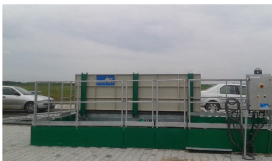
Echipament spălat roți
